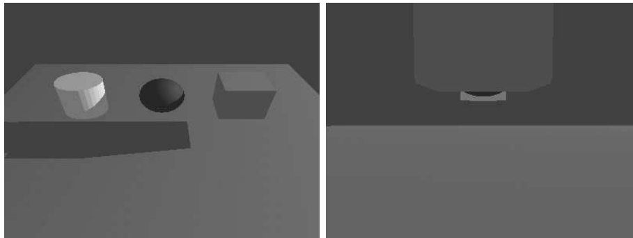
Abb.5: z Pass Schattenvolumen-Algorithmus: links: Objekte schattieren sich gegenseitig, rechts: Fehler, wenn Betrachter sich im Schattenvolumen befindet
